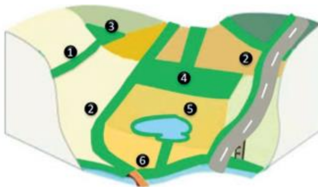
Schemat 6. Położenie stref buforowych w zlewni: 1 – strefa buforowa w obrębie pola położonego na stoku, stosowana do podzielenia dużych pól na mniejsze, 2 – strefa buforowa na skraju pola, chroniąca drogę (potencjalna droga spływu wody), 3 – strefa buforowa położona na skraju pola w jego dolnym narożniku, zapobiegająca zbieraniu się tam wody, 4 – dolinka spływu porośnięta trawą, ograniczająca spływ powierzchniowy skoncentrowany, 5 – duża zadarniona strefa buforowa, np. łąka, służąca do zatrzymania i rozpraszania spływu skoncentrowanego zasilanego z położonej powyżej dolinki spływu (wspomaga przesiąkanie wody), 6 – nadbrzeżna strefa buforowa (między granicą pola a brzozi odbiornika wodnego, porośnięta trawą) założona w celu zatrzymania spływu powierzchniowego dopływającego z położonego wyżej pola (źródło: CORPEN/ IRSTERA, zmodyfikowane).
